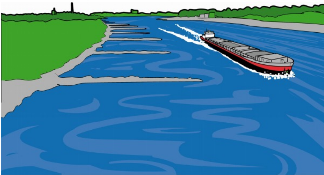
Abb. 1: Ein Schiff durchfährt einen Fluss in den mehrere Buhnen hineinreichen
